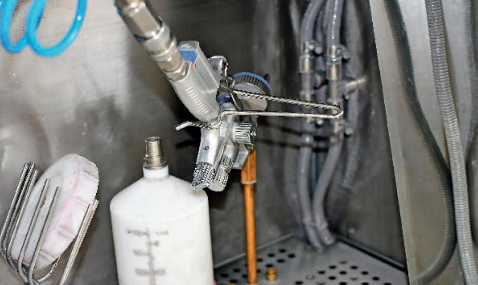
E2C ersetzt Verdünnung bei der Reinigung von Pistolen, mit denen lösemittelhaltige Lacke appliziert wurden.
