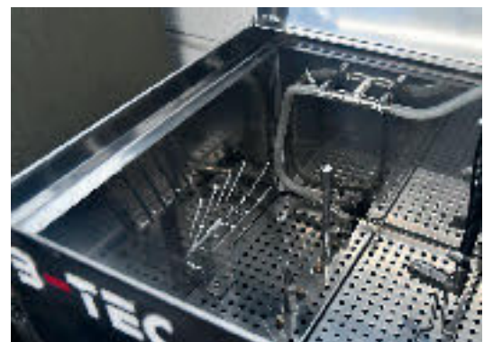
Angenehmer Nebeneffekt: Auch der Pistolenwaschautomat ist beim Einsatz des Reinigungsmittels extrem leicht zu säubern.
